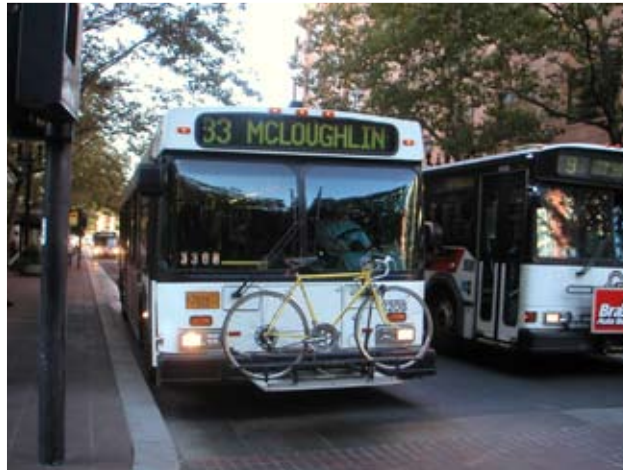
路線バスに設置された自転車ラック
