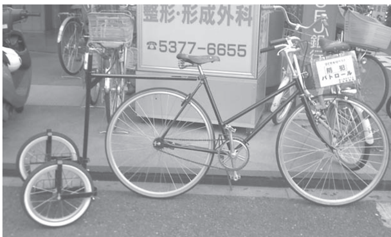
タンデム車ではありませんが、子どもを立たせて移動する牽引車両です。日本製で、自転車の後部ブレーキはコースターブレーキです。
