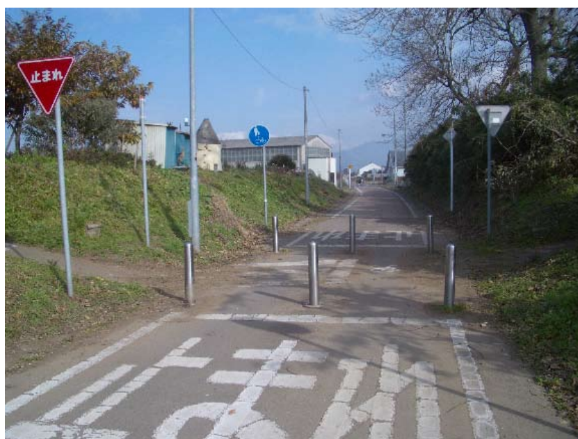
写真1 ほとんど交通量のない交差路に対しても、一旦停止標識と車止めが設置されている
