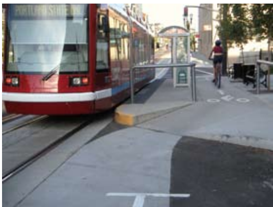
上写真：LRT（ライトレール）の停車場でも自転車レーンが歩行者と分離され、とぎれないようになっている（ポートランド）
