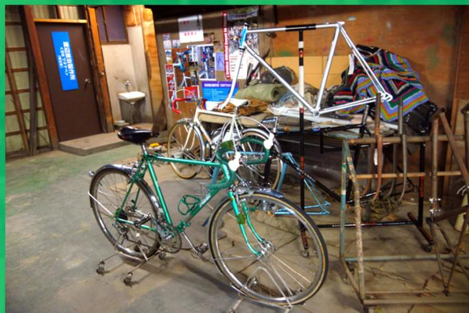
「巴里の宝石」と謳われたフランスの自転車工房 RENE・HERSE に端を発するDEMONTABLE RHでは、フレームを前後で2分割して車のトランクに積み込みヴァカンス旅行中に楽しむ形態でした SWでは、ダートの林道を走るハード・サイクリングに適応する輪行目的の分割式小旅行車に仕上げました フレーム剛性と弾力感の出るしっかりした素材にスペシャル加工を施して11.7kgの軽量車に収まりました オーナーが渡辺捷治氏とほぼ同じ体格なので渡辺車と同じMTBの26HE径の車輪にしています 小径車を感じさせないブルベ・ランドネ並みの巡航速度で快走する「軽く！楽に！速い！」進むSW 万能車として様々な旅の場面で実力を発揮する疲れを残さないランドヌール系統のデモンターブルです オーナーが51歳であることから製作所の51周年モデルとして50周年と同じ記念ロゴで飾っています
